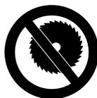
Никогда не применяйте пильные диски, а также твердосплавные, спасательные, дереворежущие или иные зубчатые инструменты – **опасность получения смертельной травмы!** В противоположность равномерному съему частиц при пользовании абразивно-отрезными дисками зубья пильного диска при резке могут зацепиться в материале. Это способствует агрессивной резке, что может привести к неконтролируемому, чрезвычайно опасным реакциям (обратному удару) устройства.
